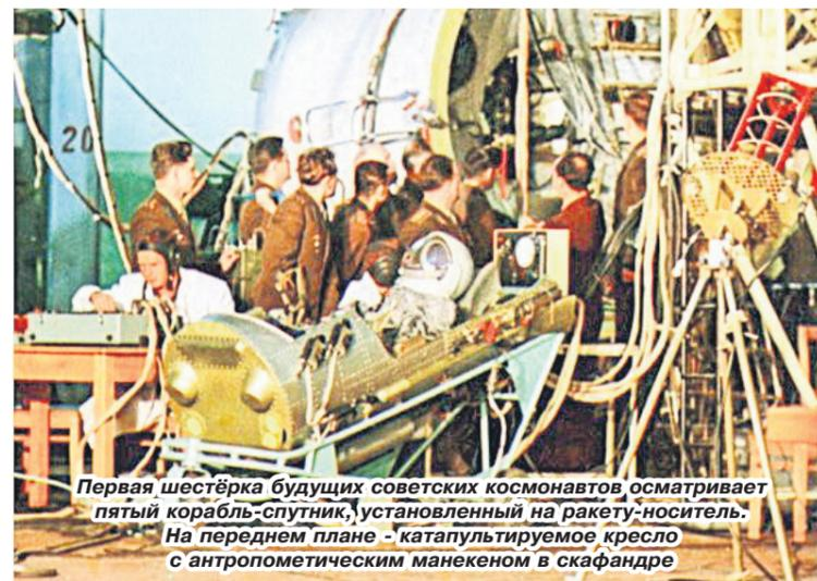
Первая шестёрка будущих советских космонавтов осматривает пятый корабль-спутник, установленный на ракету-носитель. На переднем плане - катапультируемое кресло с антропометрическим манекеном в скафандре
